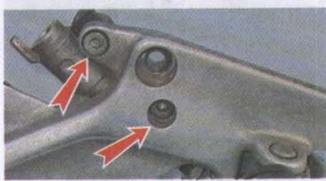
18. Снимаем тормозной цилиндр в сборе с кронштейном датчика сигнала торможения.
