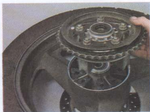
1. Снимаем ведомую звездочку привода в сборе, как показано на фото.
