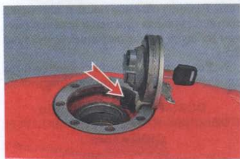
Стрелкой показано отверстие, связывающее топливный бак с атмосферой
