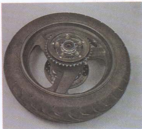
1. Снимаем ведомую звездочку привода в сборе, как показано на фото.
