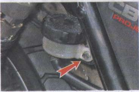
17. Шестигранным ключом на 5 мм отворачиваем два болта крепления тормозного цилиндра.
