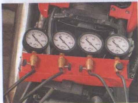
Вакуумметр с четырьмя манометрами для синхронизации карбюраторов
