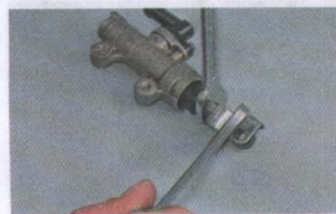
19. Удерживая, рожковым ключом на 16 мм наконечник штока, ключом на 12 мм ослабляем затяжку контргайки наконечника.
