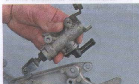
19. Удерживая, рожковым ключом на 16 мм наконечник штока, ключом на 12 мм ослабляем затяжку контргайки наконечника.
