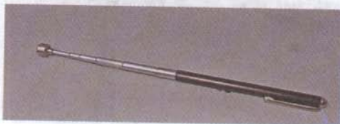
14. Магнит на телескопической указке для извлечения мелких стальных предметов из труднодоступных мест.
